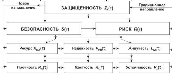
Рис. 1. Традиционный и новый алгоритмы определения и обеспечения защищенности высокорисковых машин
