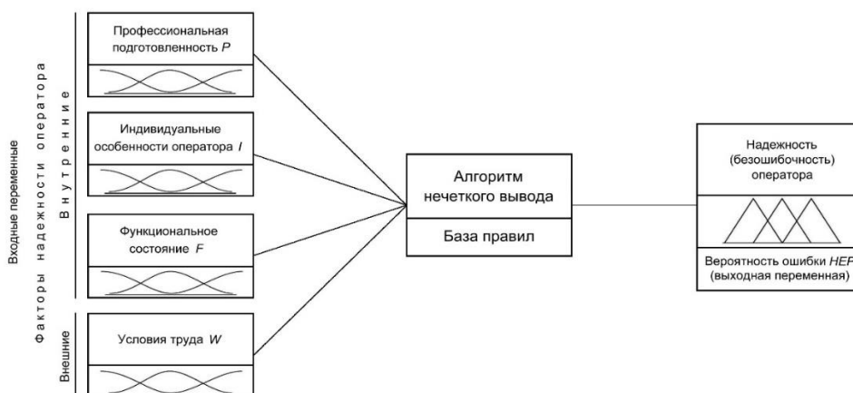
Рис.1. Схема нечеткой модели надежности оператора
