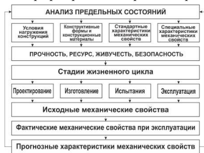
Рис. 3. Структура анализа условий достижения предельных состояний
